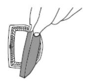
۴. پارچه فیلتر را در بیاورید و روکش آبی رنگ فیلتر را جدا کنید و برای تمیز کردن آن از برس استفاده نمایید. سپس وقتی کاملا خشک شد، روکش فیلتر را به پشت دستگاه نصب کنید.
